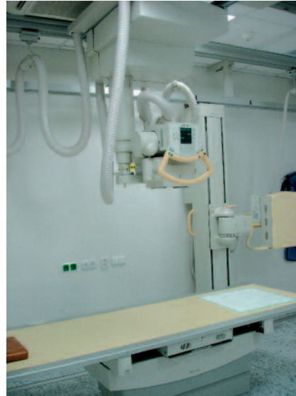
Nové pracoviště přímo digitalizované skiografie s automatickým skládáním snímků
